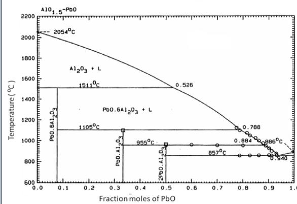
**Figure 2.**  $Al_2O_3$ -PbO phase diagram.<sup>2</sup>
